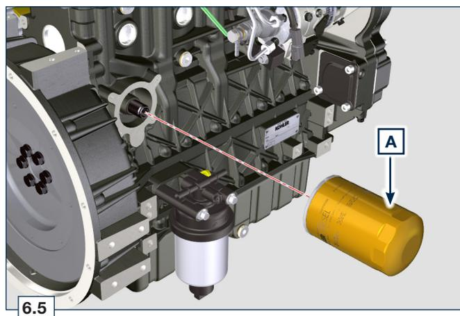
2. Inserire e avvitare la nuova cartuccia filtro olio A serrandola con chiave dinamometrica B (coppia di serraggio a 15 Nm).
