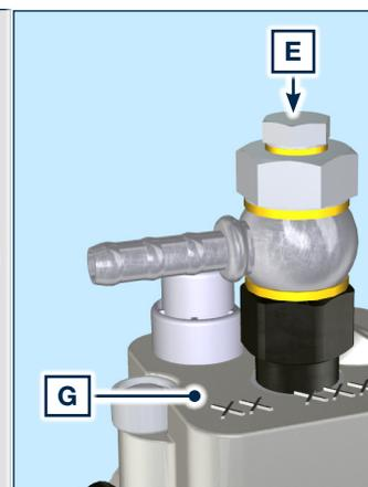
6. Avvitare la vite disareazione F e E (coppia di serraggio a 1.5 Nm) non appena il carburante inizia a fuoriuscire.
