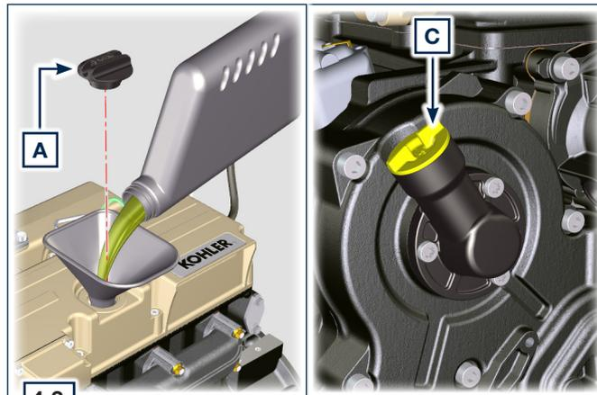
3. Prima di controllare il livello dell'olio motore assicurarsi che la macchina sia su un piano.
